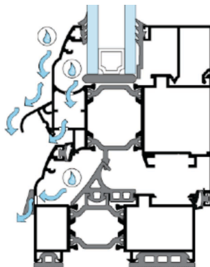
Σχήμα 2.1.2: Σχηματική παράσταση εξόδου υδάτων από το κούφωμα.
