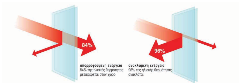
Σχήμα 1.2.8: Συνεισφορά επίστρωσης Low-e στη μείωση της απορροφούμενης ενέργειας
