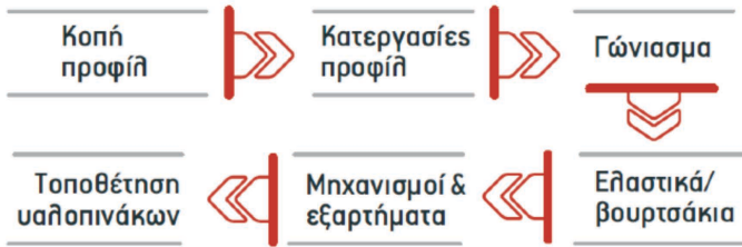
Σχήμα 2.1.1: Βασικά στάδια κατασκευής κουφώματος αλουμινίου
