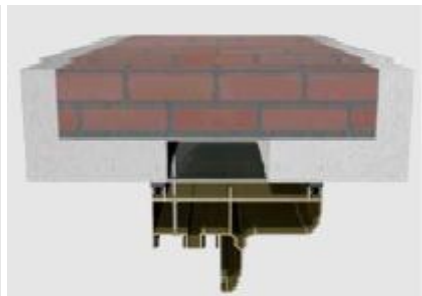
Τοποθετημένο κούφωμα στο κέντρο του λαμπά
