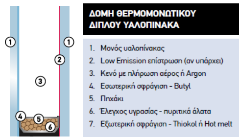
Σχήμα 1.2.4. Δομή διπλού θερμομονωτικού υαλοπίνακα
