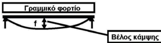
Σχήμα 2.5. Δημιουργία βέλους κάμψης από γραμμικό φορτίο
