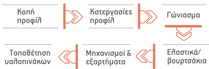
Σχήμα 7.1. Στάδια κατασκευής κουφώματος αλουμινίου
