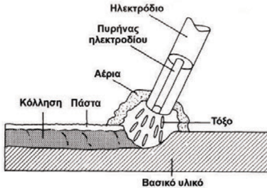
Σχήμα 9.6. Διαδικασία συγκόλλησης τόξου
