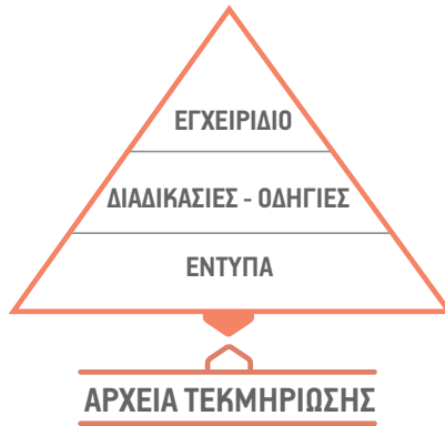
Σχήμα 8.3. Ανάπτυξη συστήματος ελέγχου παραγωγής υπό τη μορφή πυραμίδας
